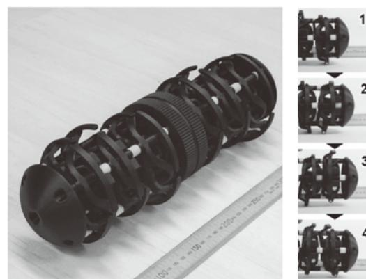
図4, 試作した全方向波送りユニット
