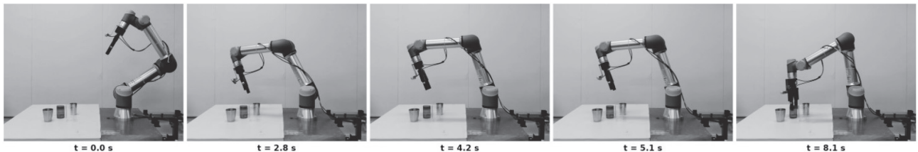
図：提案手法 HEAPGrasp による透明物体ピッキング実行例
