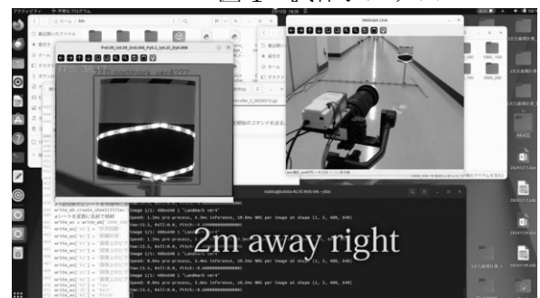
図2 ランドマーク検出・追従実験例
